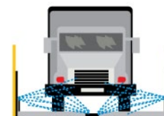
Rys. 3. Myjnia dla pojazdów budowy
